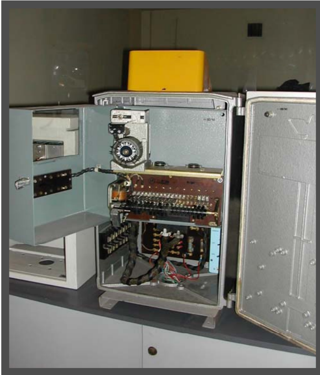
Equipo controlador Eagle-Corti de Tecnología Electromecánica
