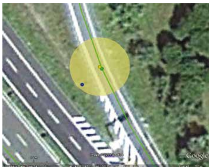
3. Il confronto delle posizioni del tank container misurate con GPS (blu), e corrette con EGNOS in conformità con CWA 16390 (giallo e relativa confidenza), rispetto alla posizione georeferenziata (verde)
