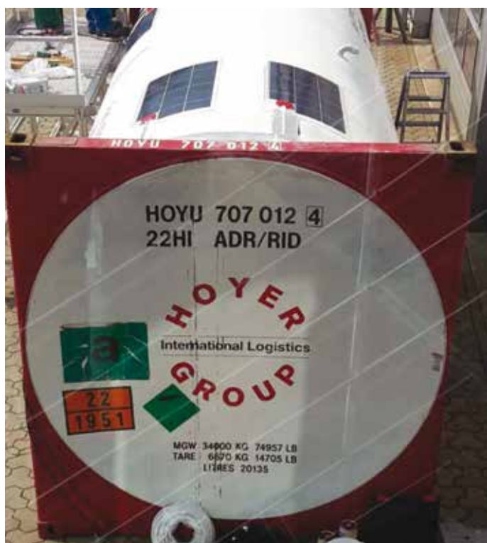
2. Il tank container di HOYER per il trasporto di Argon equipaggiato con dispositivo di tracciamento basato su EGNOS e Galileo/multi-GNSS nella dimostrazione pilota del progetto CORE
